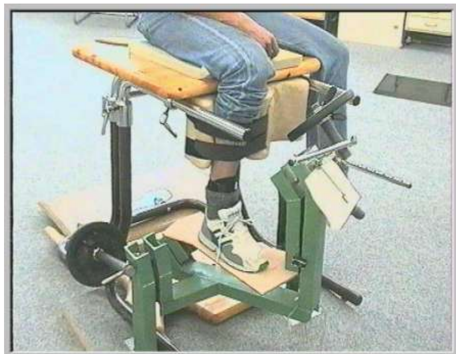
Abb. 3a, das Winkelmeßgerät zur Bestimmung der Auslenkwinkel bei Einleitung bestimmter Drehmomente bzgl. der Sprunggelenkachsen.
